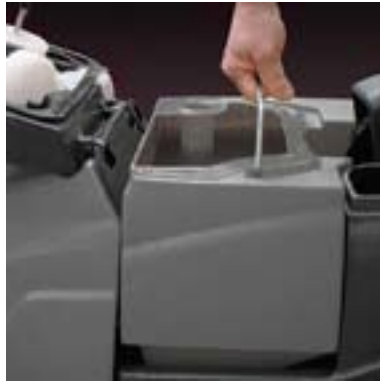
A2 Depósito agua sucia
